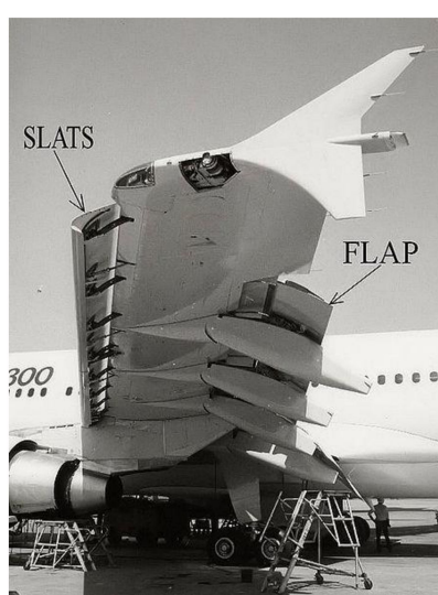
Рисунок 2.45. Механизированное крыло самолета А-310 в посадочной конфигурации (слева) и сравнение поляры крыла, рассчитанной в работе [98] с использованием моделей SST и SSG/LRR RSTM, с экспериментальными данными (справа)
